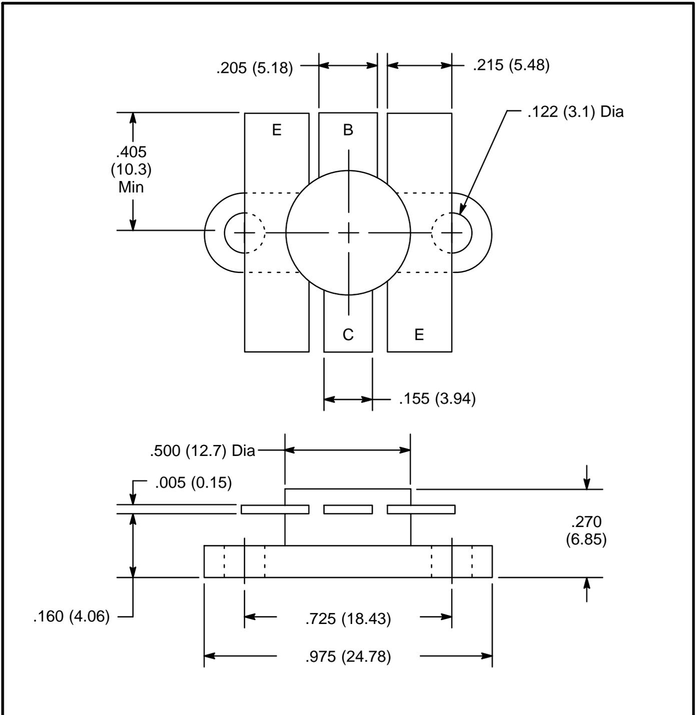
TOSHIBA TRANSISTOR SILICON NPN EPITAXIAL PLANAR TYPE
